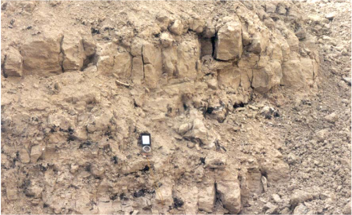
Figur 18. Tætsiddende vertikale sprækker i bryozokalk i udgravning i Sydhavnsgade, København, tæt på Carlsbergforkastningen (foto: Peter Roll Jakobsen).
