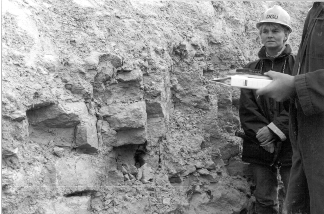
Figur 21. System af parallelt orienterede vertikale sprækker i København Kalk Formationen i midlertidig udgravning på Amager (foto: Peter Roll Jakobsen).
