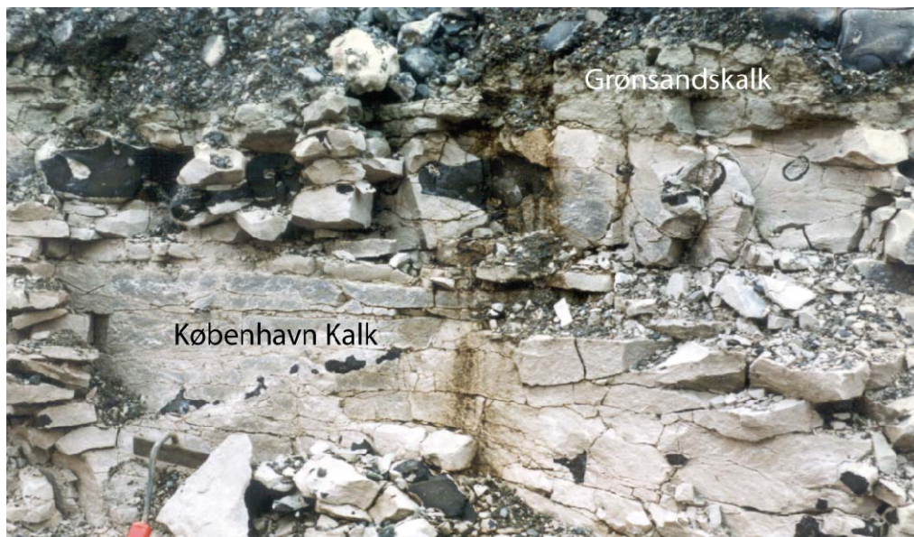
Figur 14. Grænse mellem København Kalk Formationen og Lellinge Grønsand Formationen (grønsandskalk) i udgravning ved Amagers østkyst (foto: Peter Roll Jakobsen).
